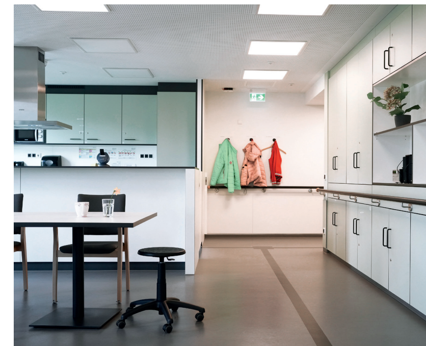
Dimmbare, deckennahe Leuchten, eine Akustikdecke sowie Handlauf und Leitlinien unterstützen die Orientierung.
